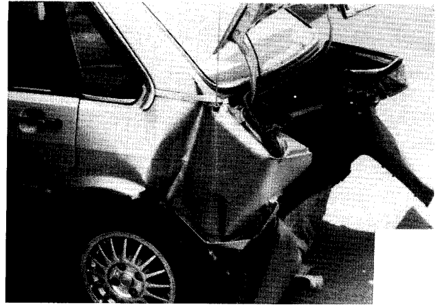
So sieht angeblich ein Pkw aus, dem ein anderer Pkw mit einer Geschwindigkeit von 30 km/h aufgefahren sein soll.
